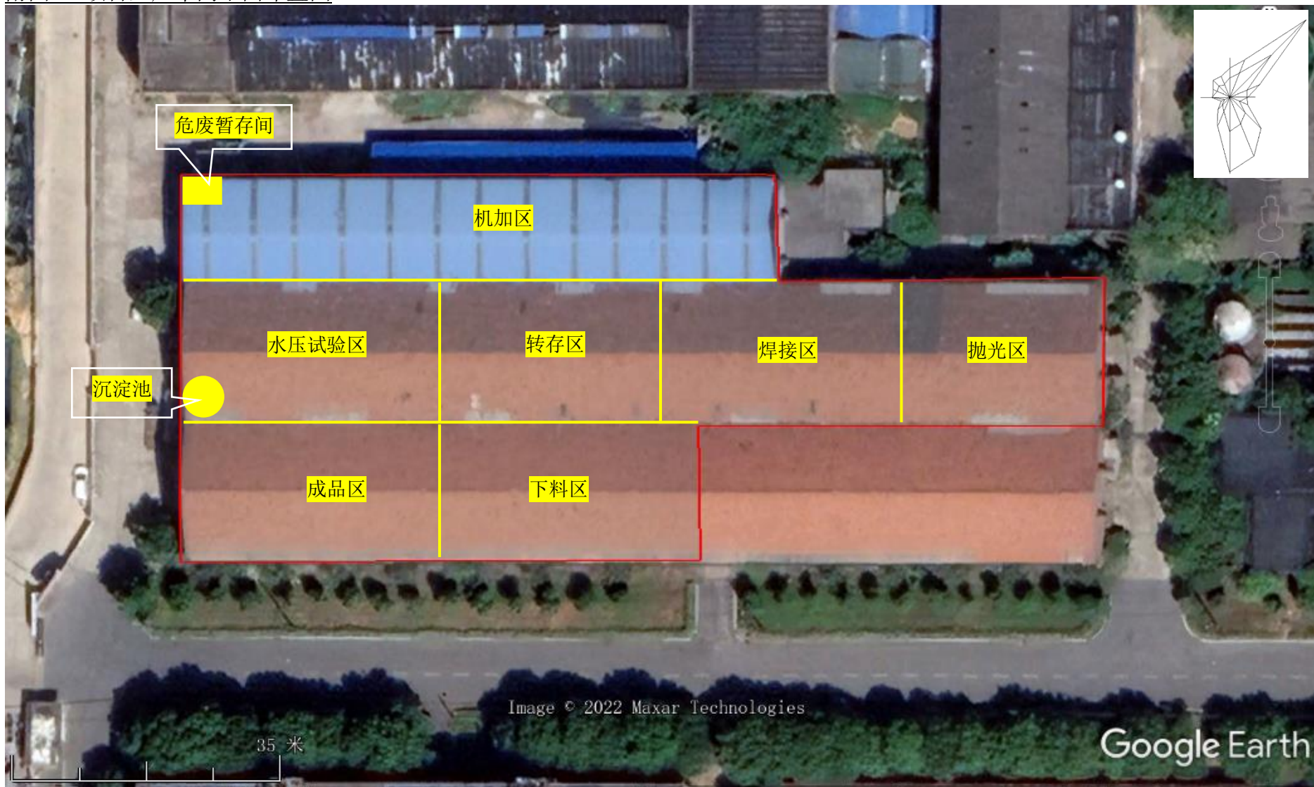
附图3 项目生产车间平面布置图
