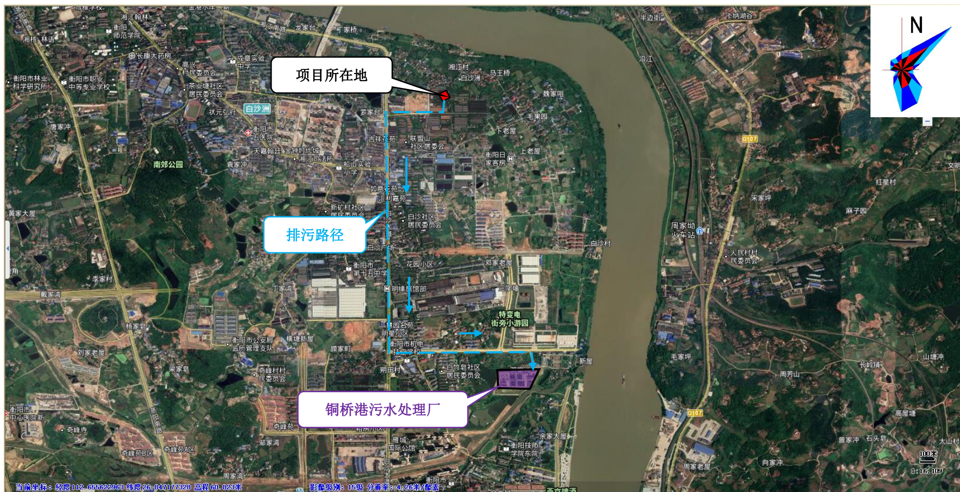
附图 6-2 污水管网及排水路径图
