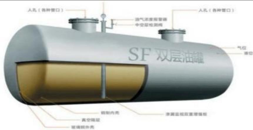
图 2-7 SF 双层油罐构造
