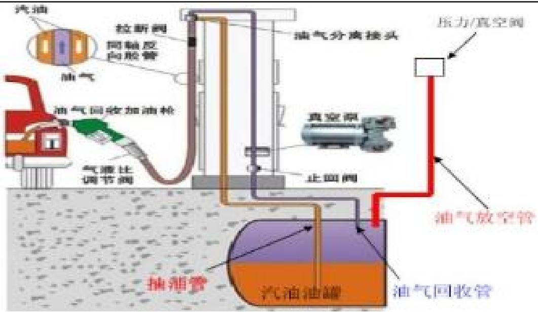
图2-4 二次油气回收系统示意图
